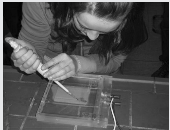
Abb. 14: Eine Schülerin befüllt die Taschen der Gelkammer mit den PCR-Proben
